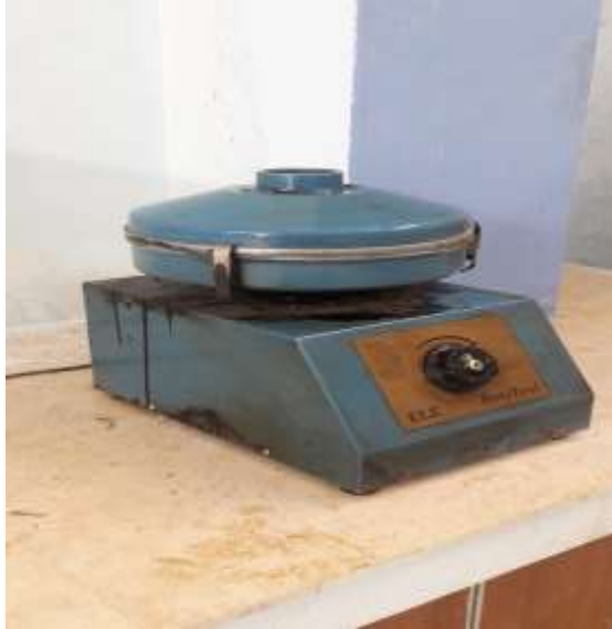
جهاز الاستخلاص تحديد نسبة الاسفلت والتركيب الحبي للمجبول الاسفلتي المستخدم
