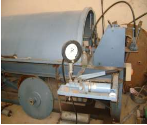
جهاز اختبار الضغط لأنابيب الفولاذ والفونت المرن
