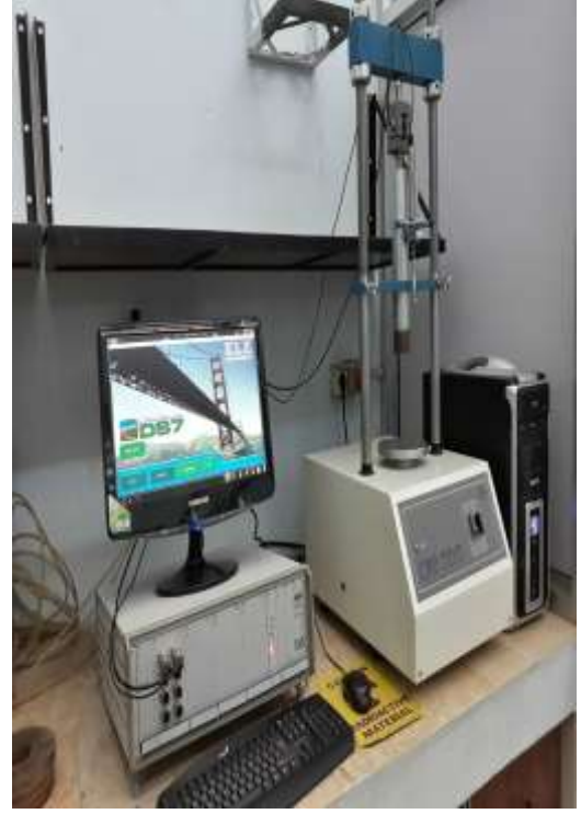
جهاز نسبة التحميل الكاليفورنية تحديد تحمل التربة
