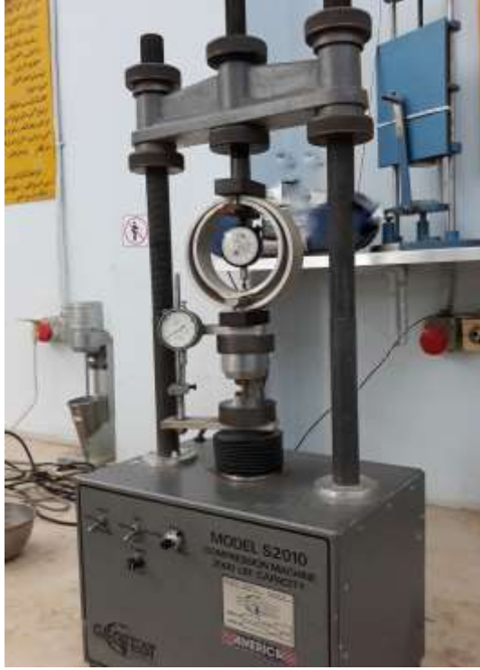
جهاز الضغط الحر تجربة سريعة لتعيين عوامل القص
