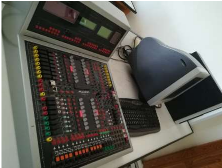
يتضمن هذا القسم تجارب على لوحة التجارب MCU AVR : عدد اللوحات: ٩
