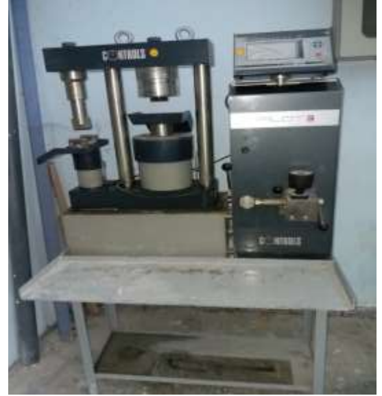
جهاز كسر المونة الاسمنتية على الشد بالانعطاف والضغط
