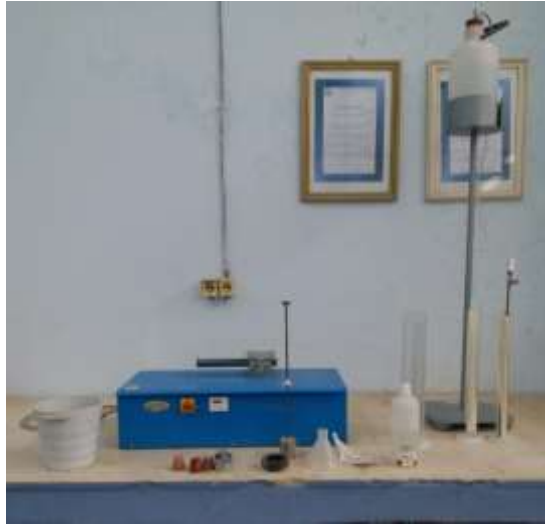
جهاز اختبار المكافئ الرملي
