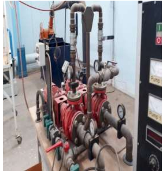
جهاز اختبار عمل المضخات على التسلسل والتفرع
