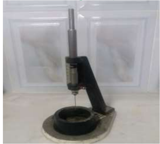
جهاز فيكا ( يدوي وكهربائي ) لتحديد القوام القياسي للعجينة الاسمنتية
