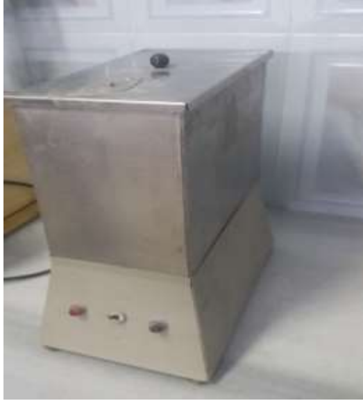
أبرة لوشاتولييه + غلاية لوشاتولييه تجربة انتفاخ الاسمنت
