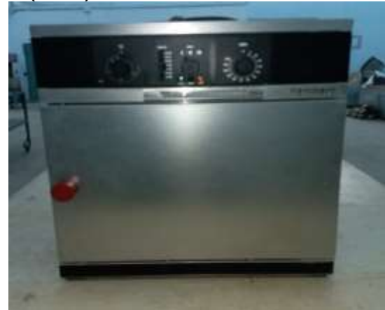
فرن تجفيف حتى درجة حرارة (٢٥٠) درجة + حوض مائي لحفظ العينات في الماء
