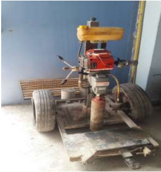
جهاز نزع الجزرات الإسفلتية تحديد السماكة ودرجة الرص في طبقات الرصف المنفذة
