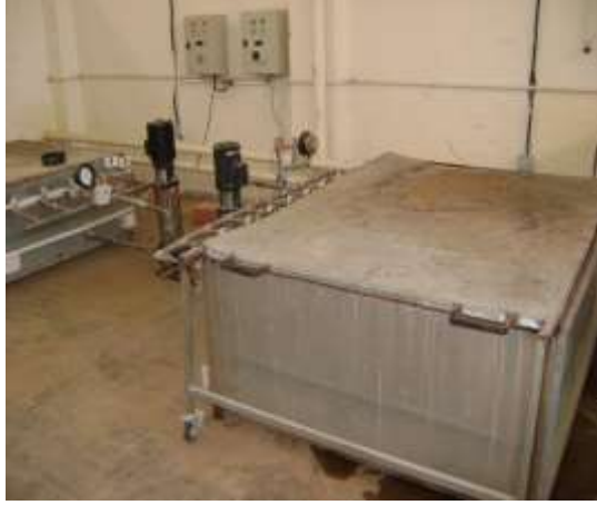
جهاز اختبار الضغط طويل الامد (الديمومة)
