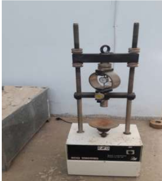
جهاز كسر قوالب CBR تحديد نسبة تحمل كاليفورنية للتربة CBR
