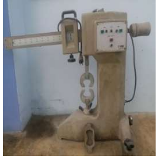
جهاز اختبار المونة على الشد
