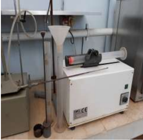
جهاز خلط التربة الكهربائي لتجربة المكافئ الرملي
