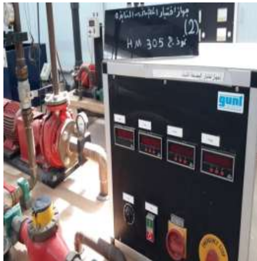
جهاز اختبار المضخة النابذة
