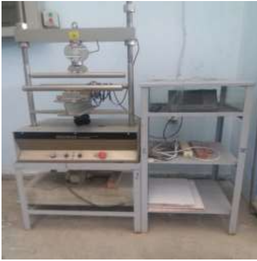
جهاز الكسر بالانعطاف لعينات البلاط والسيراميك والخشب وغيرها
