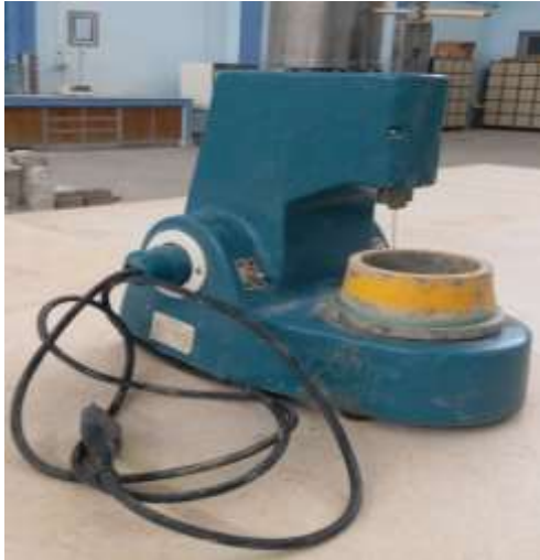
جهاز فيكا ( يدوي وكهربائي ) لتحديد زمن بدء وانتهاء التجمد
