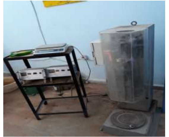
جهاز بروكتور تحديد الرطوبة المثالية الموافقة لدرجة الرص العظمى
