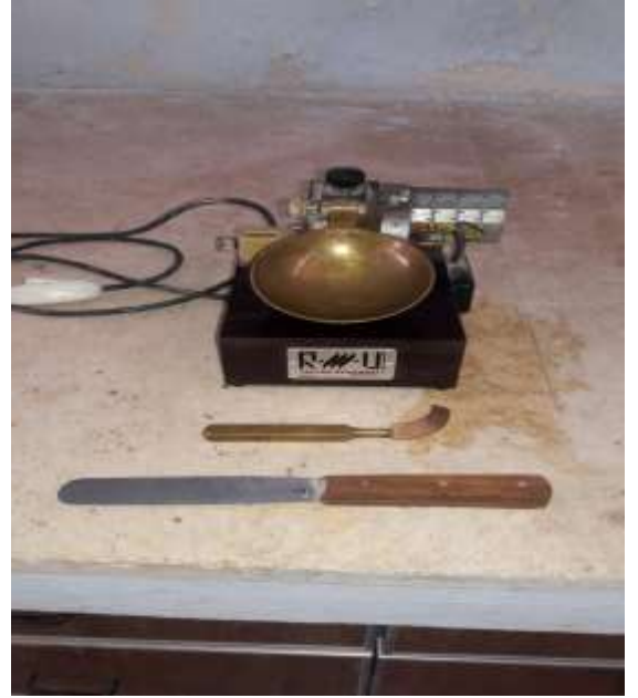
جهاز كاساغراندي اختبار تحديد حد السيولة للتربة
