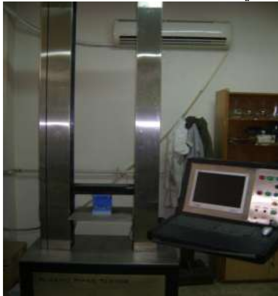
جهاز اختبارات انابيب البولي ايتيلين المضلعة للصرف الصحي
