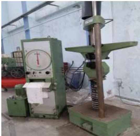
جهاز شد الحديد استطاعة حتى ٣٠ طن
