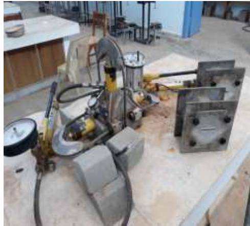
جهاز قص العينات الصخرية تحديد عوامل القص للعينات الصخرية.
