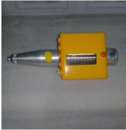
جهاز السكليرومتر لقياس مقاومة البيتون بالمطرقة
