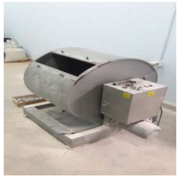
جهاز كسر قوالب مارشال اختبار تحديد الثبات والسيلان لقوالب مارشال
