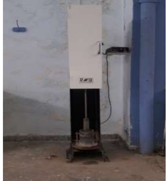
جهاز مطرقة بروكتور الآلي تحديد الرطوبة المثالية والكثافة الأعظمية الجافة للتربة
