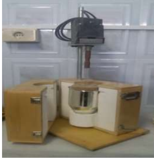
جهاز قياس حرارة تمييه الاسمنت الرقمي
