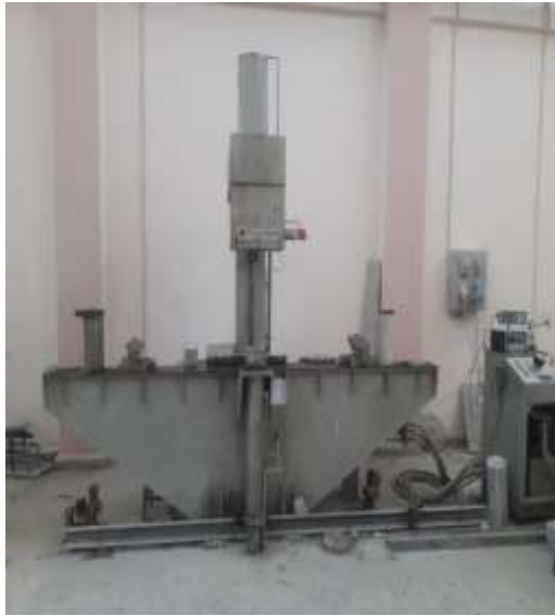
جهاز كسر الجوائز الكبيرة بحمولة حتى ١٠٠ طن
