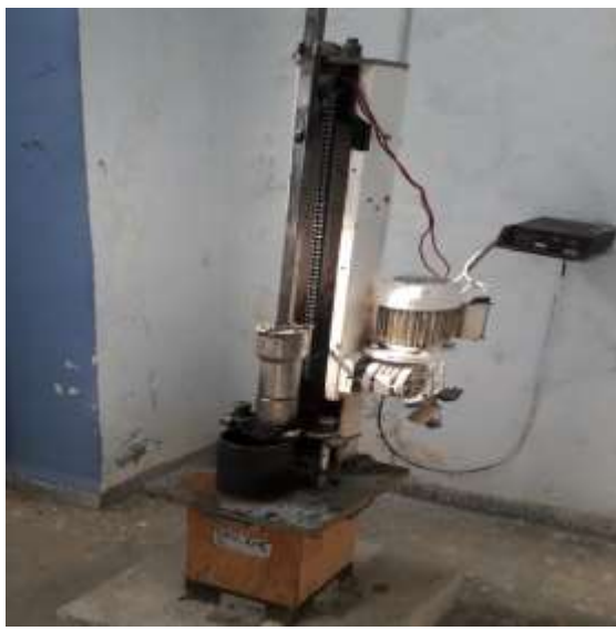
جهاز الاستخلاص تحديد نسبة الاسفلت والتركيب الحبي للمجبول الاسفلتي المستخدم
