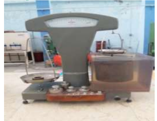
أجهزة حساب الوزن النوعي والحجمي لمواد مختلفة ميزان هيدروستاتيكي وملحقاته لعينات غير منتظمة الشكل
