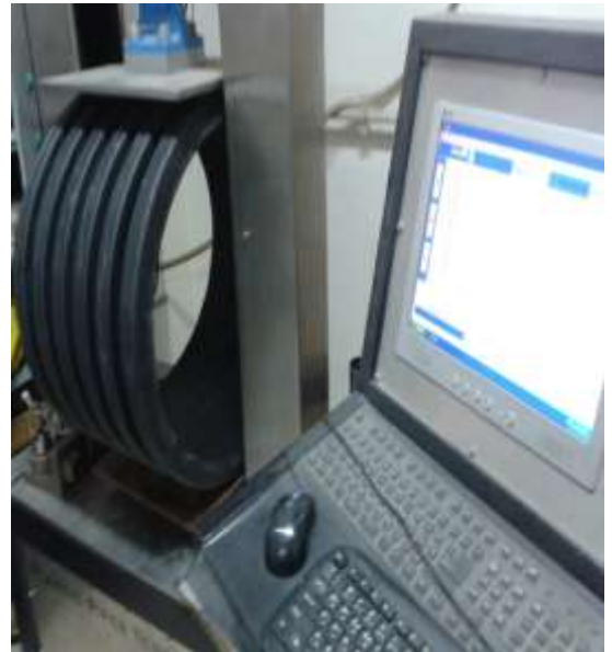
جهاز اختبارات انابيب البولي ايتيلين المضلعة للصرف الصحي
