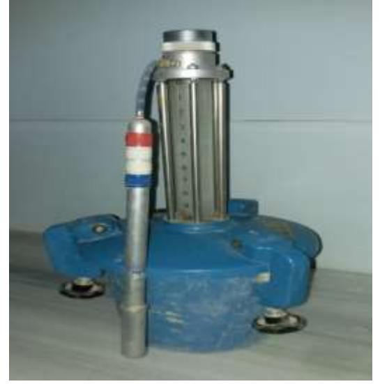
جهاز قياس كمية الهواء المحبوسة في الخلطة البيتونية
