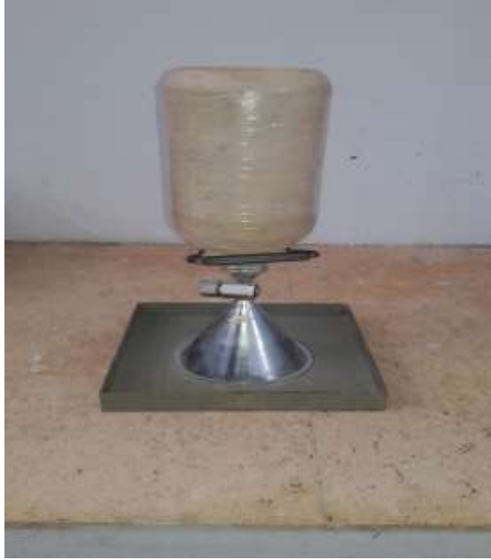
جهاز المخروط الرملي الكثافة الحقلية من أجل حساب درجة الرص
