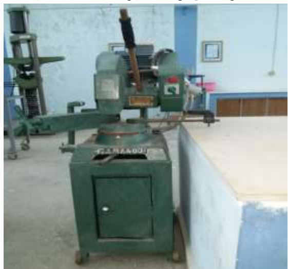
جهاز قص وتحضير عينات الحديد
