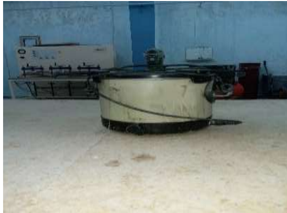
أجهزة حساب الوزن النوعي والحجمي لمواد مختلفة ميزان هيدروستاتيكي وملحقاته لعينات غير منتظمة الشكل
