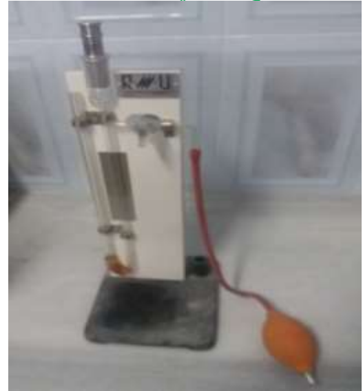
جهاز بلين قياس السطح النوعي للإسمنت
