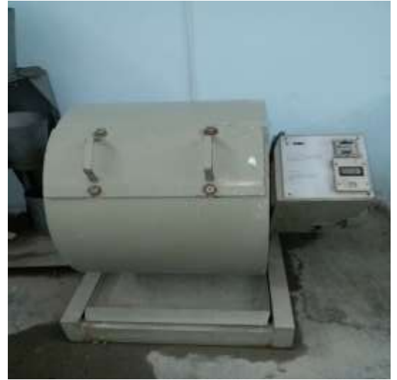
جهاز لوس انجلوس تجربة اهتراء المواد الحصوية
