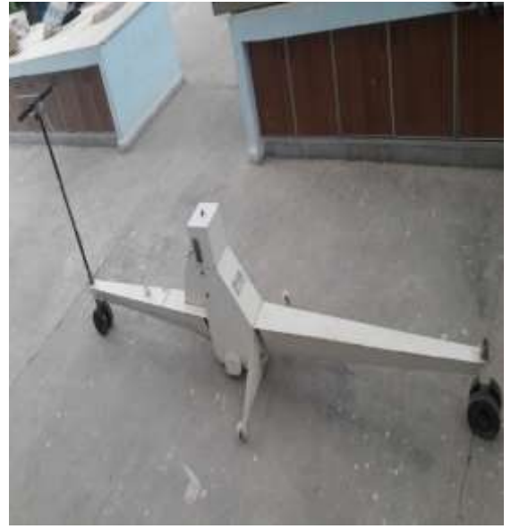
جهاز خشونة اختبار تحديد خشونة الطبقة السطحية للطرق
