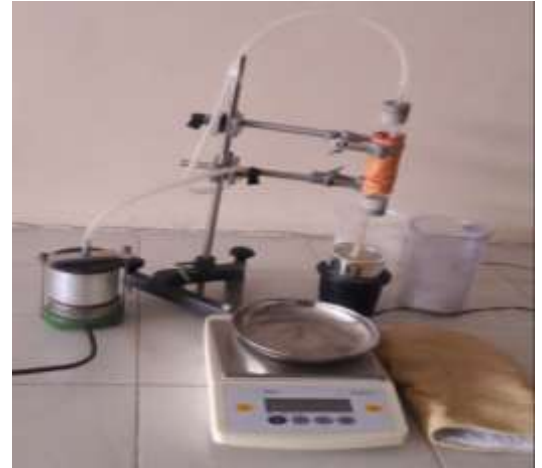
تجربة حرارة التبخر النوعية للماء Qv
