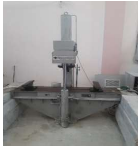
جهاز كسر الجوائز الصغيرة بحولة حتى ٣٠ طن
