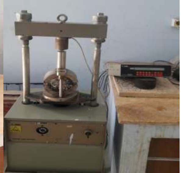
جهاز كسر قوالب مارشال اختبار تحديد الثبات والسيلان لقوالب مارشال
