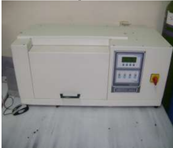
جهاز اختبار الأشعة فوق البنفسجية لأنابيب البولي ايتيلين
