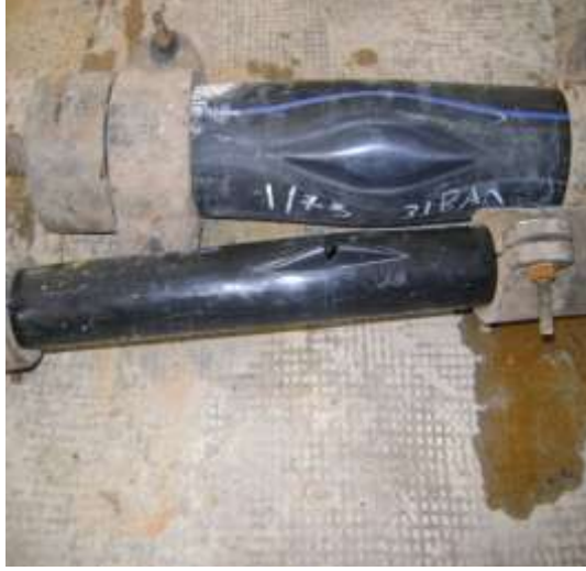
شكل انفجار العينات بالضغط المباشر
