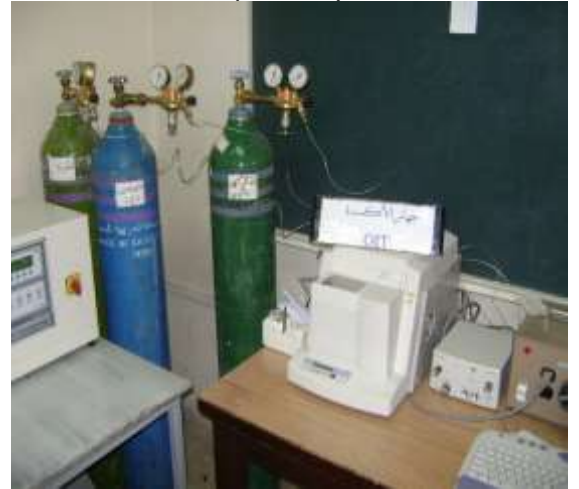
جهاز اختبار الاكسدة (OIT)
