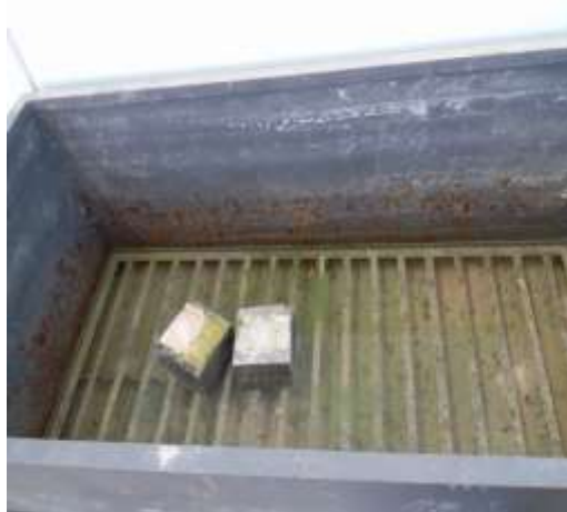
فرن تجفيف حتى درجة حرارة (٢٥٠) درجة + حوض مائي لحفظ العينات في الماء
