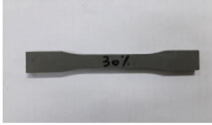
الشكل (9) عينة اختبار شد محضرة وفق مواصفة ASTM
