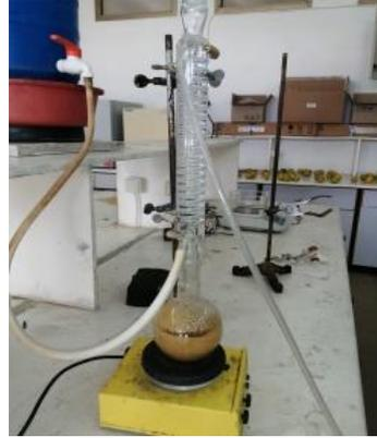
شكل (5) صورة للعينة عند المعالجة و بعد الترشيح
