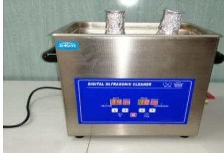
شكل (7) صورة للعينة عند المعالجة بـ NaOH في جهاز الأمواج فوق الصوتية
