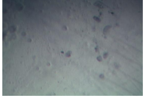
الشكل (5): صور مجهرية لغشاء الـ PVA بقوة تكبير 200x
