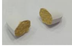
الشكل (5) : تغير في لون المضغوطات للشركة D (مضغوطات الـ Amoxicillin / Clavulanic acid) بعد 3 أشهر من تعريضها للشروط المسرعة
