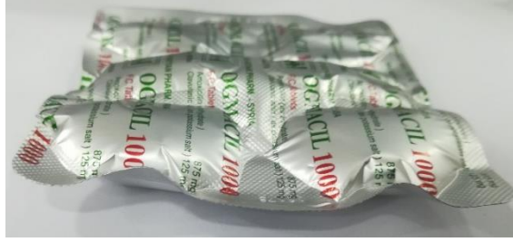
الشكل (4) : تشوه وانتفاخ التغليف للشركة C (مضغوطات الـ Amoxicillin / Clavulanic acid) بعد 3 أشهر من تعريضها للشروط المسرعة
