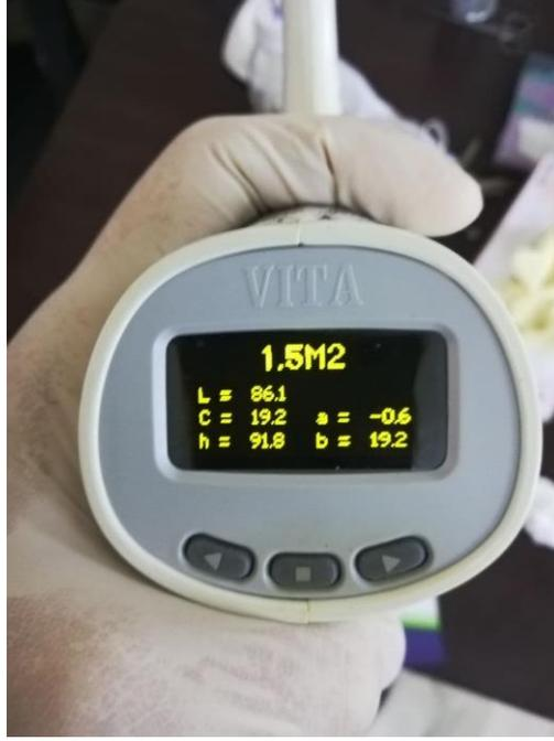
الشكل(4): يوضح قيم a,b,L المقاسه بجهاز ال Vita Easyshade compact المعتمد عليها لحساب التغيرات اللونيه
