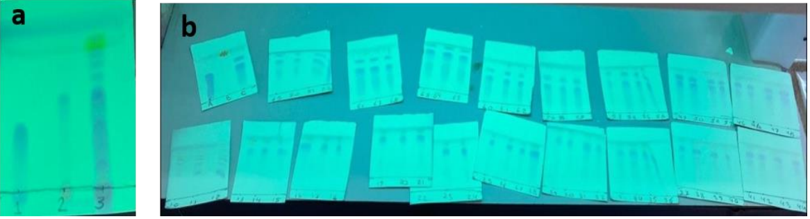
الشكل 8: (a) ناتج التفاعل بعد حله في الميثانول، (البقعة 1: الأدينين، البقعة 2: كلوروأستيل أنيلين، البقعة 3: الناتج)، (b) TLC للعينات المقطوفة من عمود الكروماتوغرافيا للناتج N-phenyl-2-(9H-purin-6-ylamino) acetamide .
