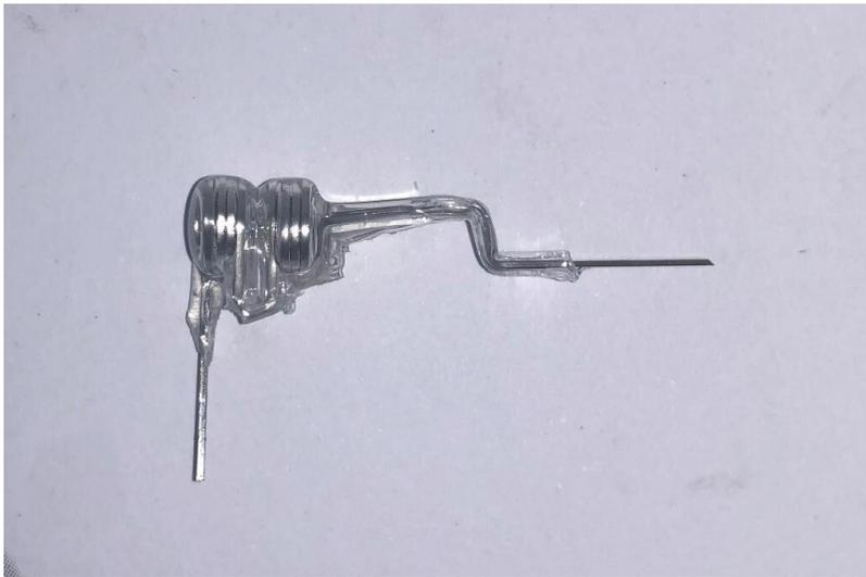
الشكل رقم (3)، السلك المساعد الحامل للمغناطيس.
