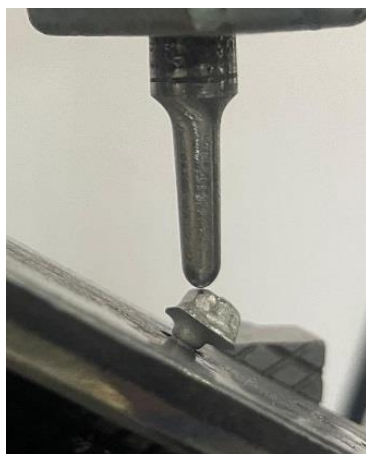
الشكل رقم (3) طريقة إجراء اختبار مقاومة قوى القص
