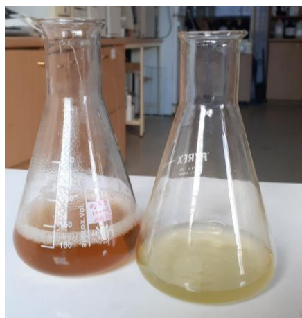
الشكل 3 تغيير اللون مؤشر بدئي لتشكّل جسيمات أوكسيد المغنيزيوم النانويّة
