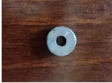
الشكل 2. القالب المعدني المستخدم في صناعة العينات
