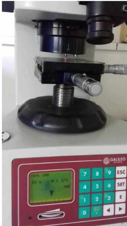
الشكل 4. جهاز اختبار القساوة المجهرية لفيكرز Galileo Durometria
