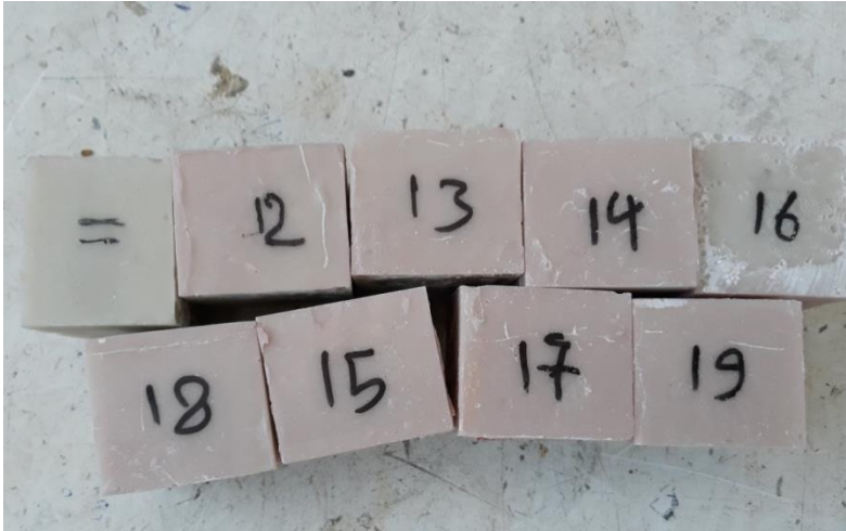
صورة(4) عينات إيبوكسي الريزين المعدل
