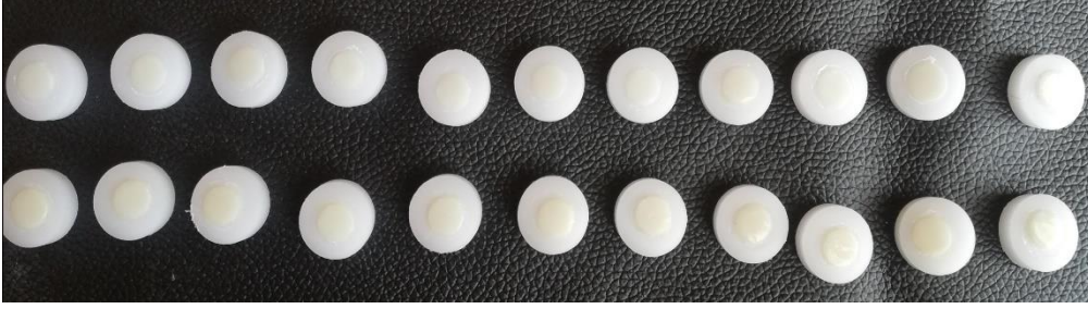
الصورة رقم(3): العينات المؤلفة من قرص خزفي ملصق على المادة البلاستيكية
