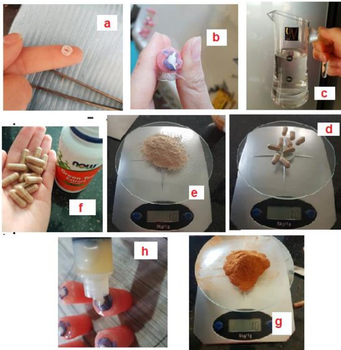
الشكل 5—Error! No text of specified style in document. (a) أنبوب البلاستيك (b) ثقب قطره 3ملم في شريط لاصق (c) معيار الماء المستخدم (d) حبوب اسكوريات الصوديوم قبل طحنها (e) مقدار البودرة من اسكوريات الصوديوم لحل المادة المضادة للأكسدة (f) كبسولات الشاي الأخضر قبل تفريغها (g) مقدار البودرة من الشاي الأخضر (h) محلول الارواء بمعدل تدفق 1ملم/دقيقة.
