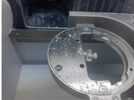
**الشكل 6: عملية النحت مع التبريد بالماء.**
