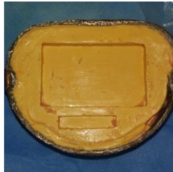
الشكل (5) تجهيز النماذج الشمعية للصب
