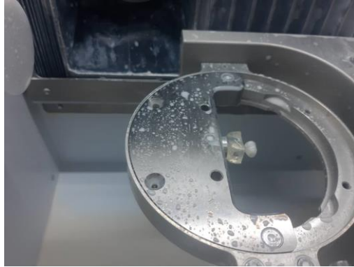
الشكل 6: عملية النحت مع التبريد بالماء.
