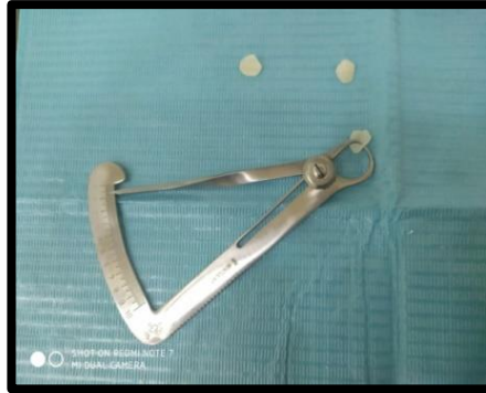
شكل(27) التأكيد من سماكة الوجوه الخزفية باستخدام مقياس السَّماكة.
