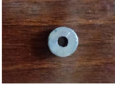
الشكل 2. القالب المعدني المستخدم في صناعة العينات
