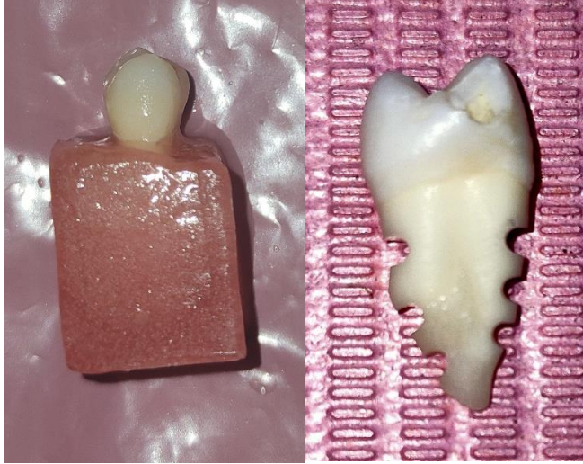
الشكل (7): تثليم سطح الجذر ، ووضع ضواك العينة ضمن اكريل ذاتي التصلب
