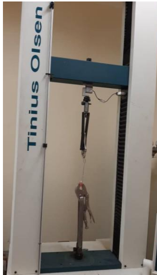
الشكل (5) : جهاز وحدة الاختبار TiniusOlsen المستخدم لإجراء اختبار قوة القص وحساب جهد القص
