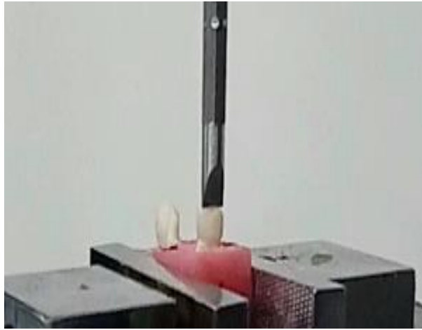
الشكل (7) اختبار الكسر فوق تاج الخزف المقوى بثنائي سيليكات الليثيوم
