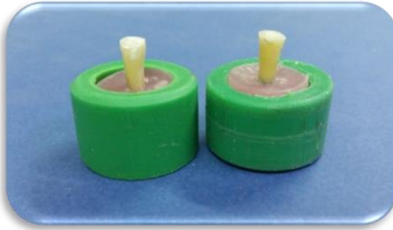
الشكل رقم (8) يوضح القوالب البلاستيكية المستخدمة وبعض جذور العينة بعد تهيئتها لاختبار مقاومة الكسر
