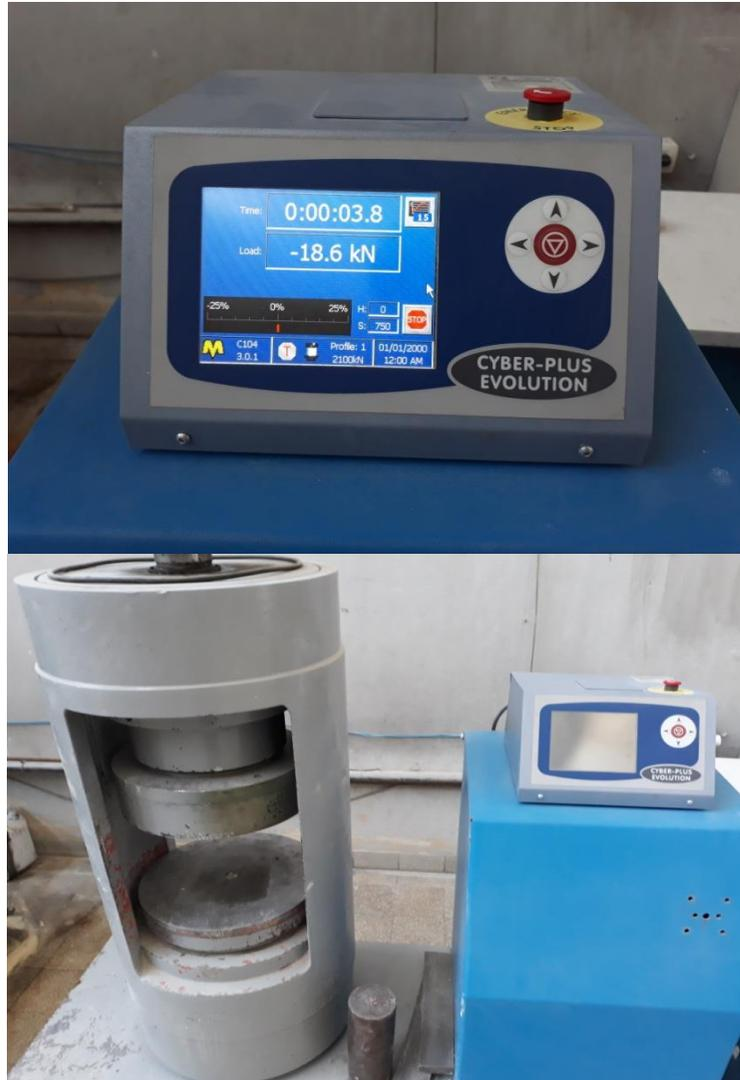
صورة(6) جهاز اختبار قوى الضغط
