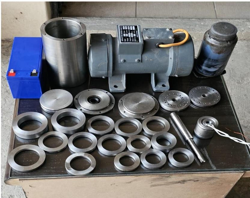
الشكل (12) مكونات المخمد المغناطيسي الريولوجي المصنع
