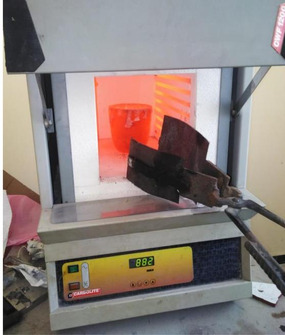
الشكل (12): الفرن الكهربائي (CARBOLITE) المستخدم لصهر سبيكة الألمنيوم وصبها
