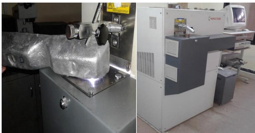
الشكل (10): جهاز التحليل الطيفي واختبار السبيكة (Al 443.0) لتحديد تركيبها الكيميائي
