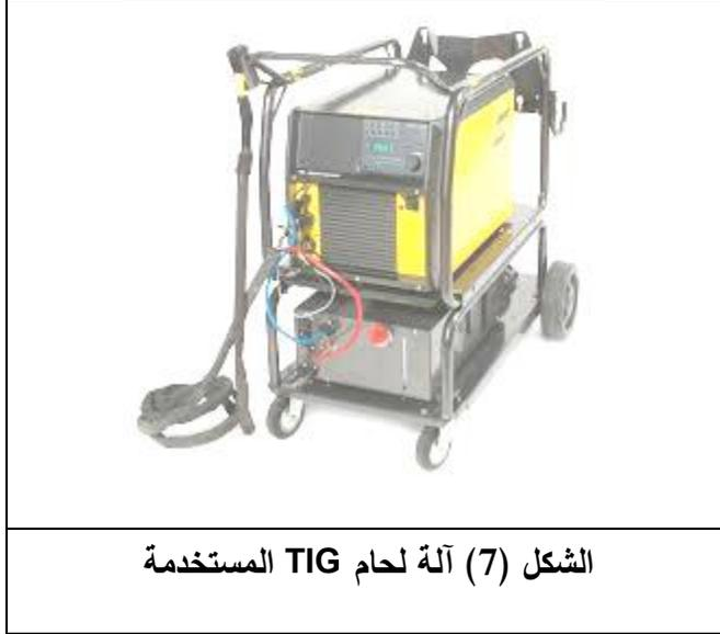
بالاعتماد على المرجع [4] نجد أنّ شدة التيار اللازمة عند لحام السماكة 5mm هي 250A ولكن باستخدام الطلاء نحتاج لتقليل شدة التيار لذا تم تجريب شدة التيار الأقل عند ثلاث قيم (160A,180A,200A) ووجد أن شدة التيار المناسبة مع وجود طلاء هي 200A. ويبين الجدول (3) بارامترات آلة اللحام.
