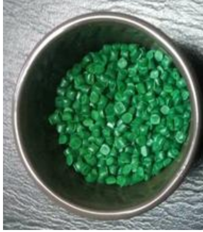
الصورة (1) حبيبات البولي إيثيلين عالي الكثافة معاد التدوير كما تم الحصول عليها من معمل مزج الزيوت
