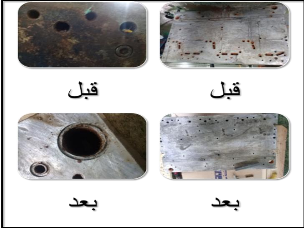
الصورة (4) قنوات التبريد قبل وبعد مشروع التحسين
