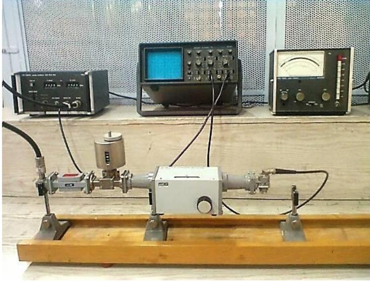
الشكل (1): دائرة قياس التخميد على الحزمة X للعينات
