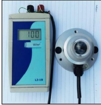
الشكل (4) جهاز قياس شدة الاشعاع الشمسي
