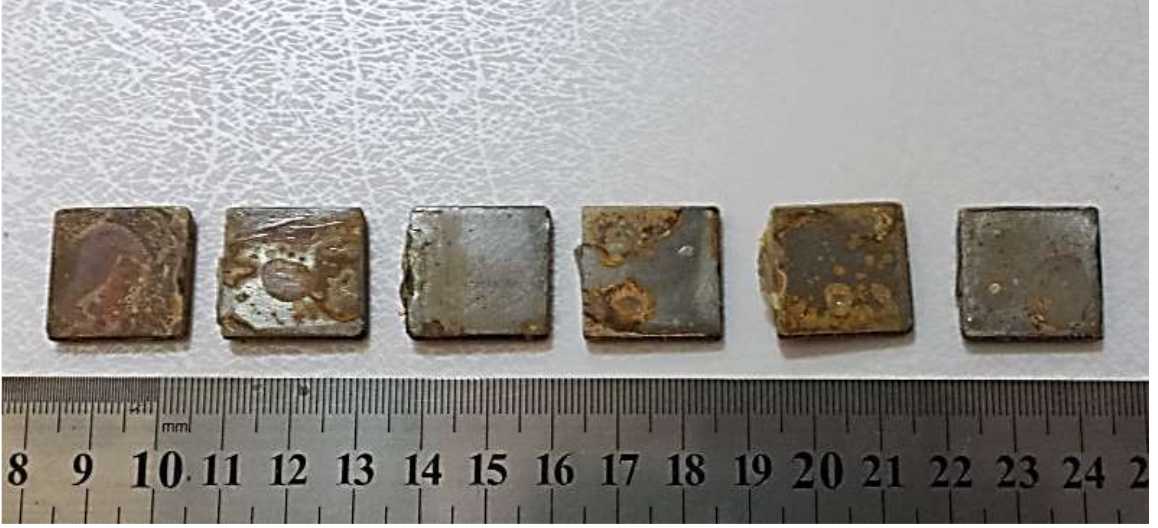
الشكل (10) يوضح صور لسطح النماذج بعد التآكل في محلول 5% NaCl
