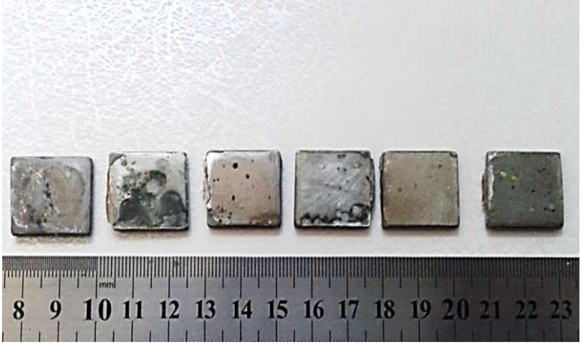
الشكل (9) صور لسطح النماذج بعد التآكل في محلول NH 4 Cl
