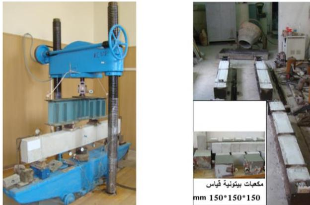
الشكل (2): شكل الجوائز المختبرة بعد صبها بالقوالب الفولاذية، وشكل جهاز اختبار الجوائز على الانعطاف.
