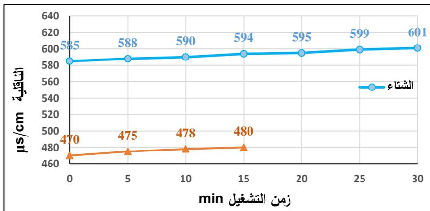
الشكل (16): تغيرات قيم الناقلية الكهربائية خلال عملية التكيف صيفاً وشتاءً
