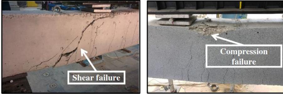
قضبان فولاذية (انهيار ضغط)      قضبان BFRP (انهيار قص)
