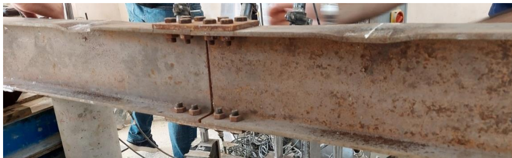
الشكل (15) : شكل الانهيار الحاصل في الوصلة المختبرة للعينة رقم 1 و 3
