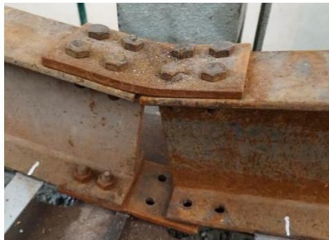
الشكل (15) : شكل الانهيار الحاصل في الوصلة المختبرة للعينة رقم 1 و 3
