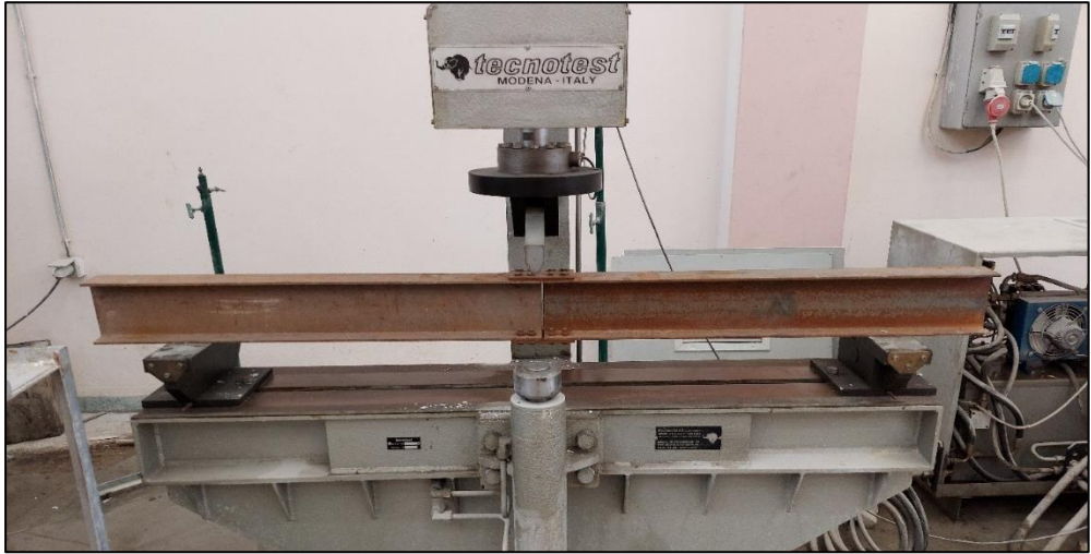
الشكل (14) : نموذج التجربة الفعلي وشكل الاستناد على جهاز الاختبار
