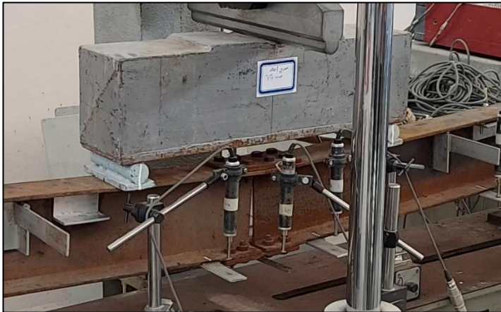
الشكل (21) : شكل التشوه للنموذج التجريبي قبيل لحظة الانهيار
