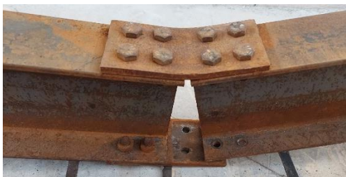
الشكل (15) : شكل الانهيار الحاصل في الوصلة المختبرة للعينة رقم 1 و 3
