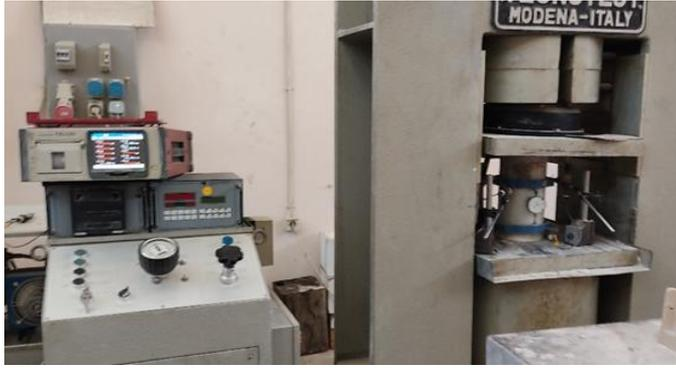
الشكل (10): تجربة الضغط وجهاز الكسر في مخبر الخرسانة
