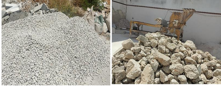
الشكل (5): صورة الكسارة المستخدمة والركام بعد التكسير
