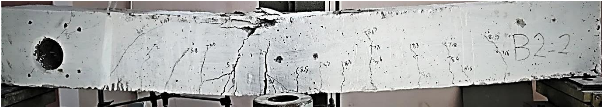
الشكل (16) انهيار الجائز B2-2
