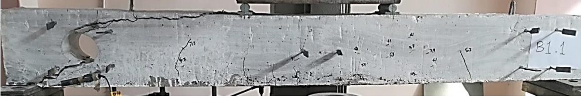
الشكل (11) انهيار الجائز B1-1
