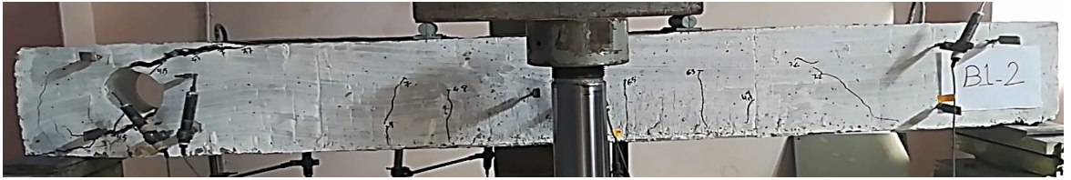
الشكل (12) انهيار الجائز B1-2
