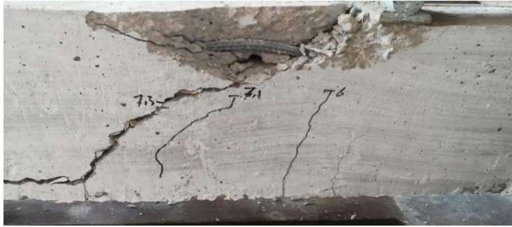
الشكل (8) الجائز المرجعي BS1 بعد الانهيار
