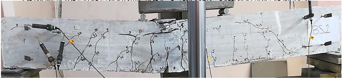
الشكل (10) انهيار الجائز المرجعي BS2
