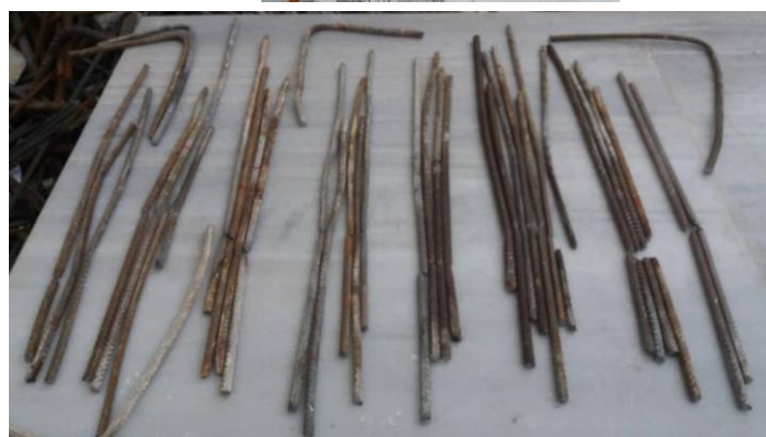
الشكل(27): عينات فولاذ التسليح المأخوذة من الأبنية المنهارة - جبلة
