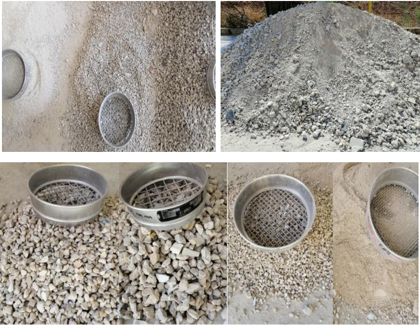
الشكل (2) الركام المعاد تدويره و طريقة فرزها على المناخل يدوياً
