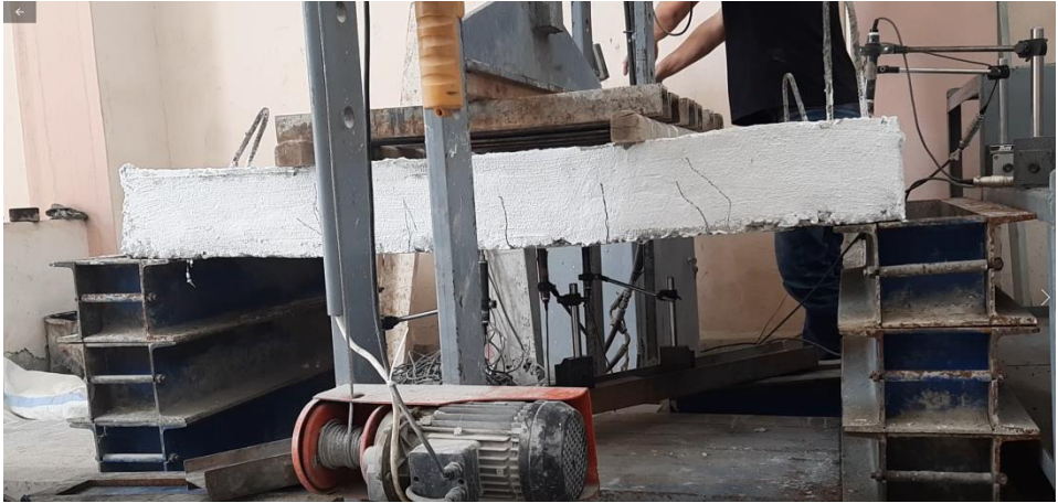
الشكل (6) شكل انهيار البلاطة (HS1-0%)
