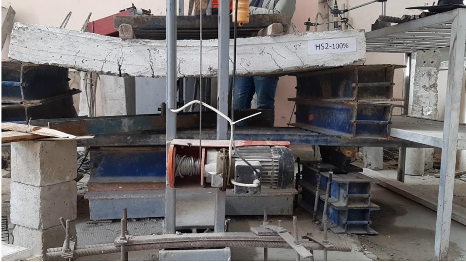
الشكل (19) شكل انهيار البلاطة (HS2-100%)
