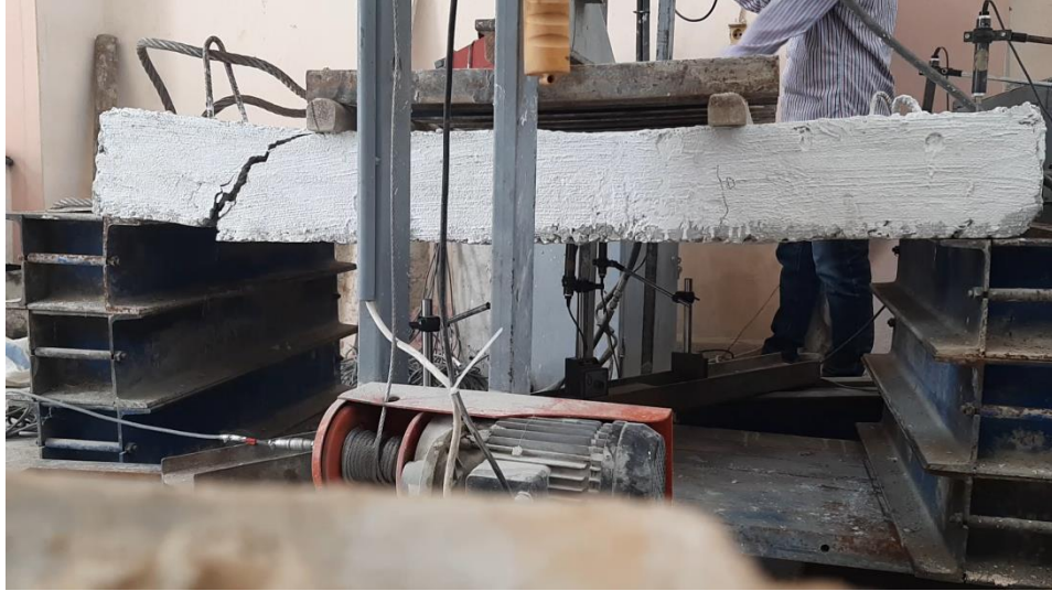
الشكل (7) شكل انهيار البلاطة (HS2-0%)
