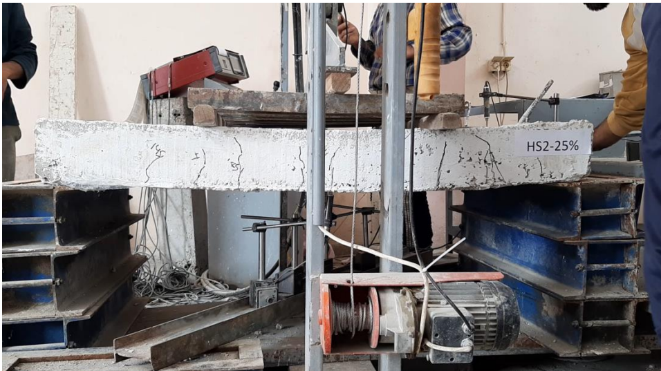
الشكل (10) شكل انهيار البلاطة (HS2-25%)
