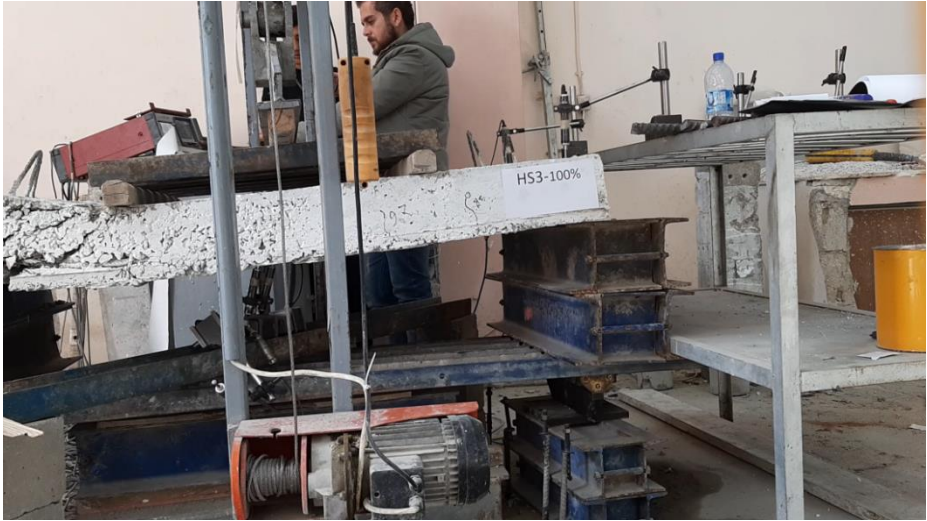
الشكل (20) شكل انهيار البلاطة (HS3-100%)
