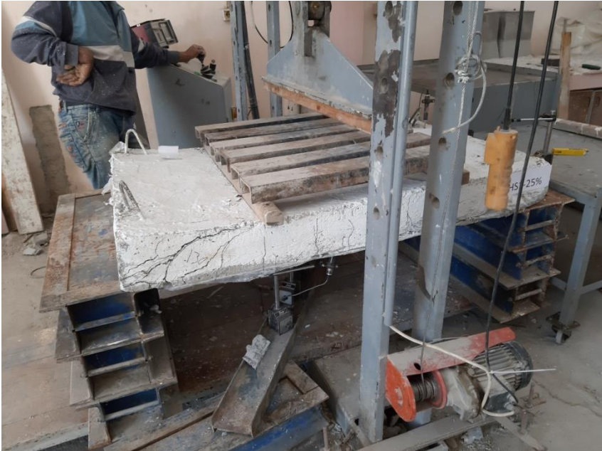
الشكل (9) شكل انهيار البلاطة (HS1-25%)
