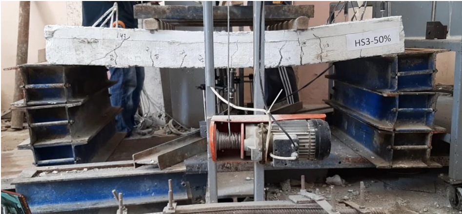
الشكل (14) شكل انهيار البلاطة (HS3-50%)
