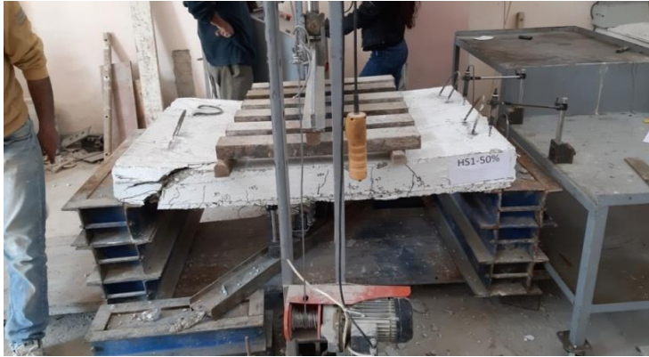
الشكل(12) شكل انهيار البلاطة(HS1-50%)
