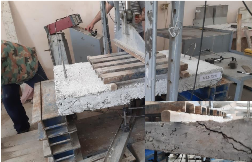
الشكل (15) شكل انهيار البلاطة (HS1-75%)
