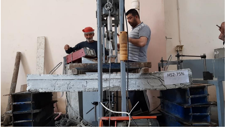
الشكل (16) شكل انهيار البلاطة (HS2-75%)
