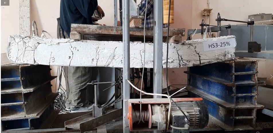
الشكل (11) شكل انهيار البلاطة (HS3-25%)
