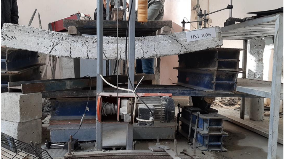
الشكل (18) شكل انهيار البلاطة (HS1S-100%)
