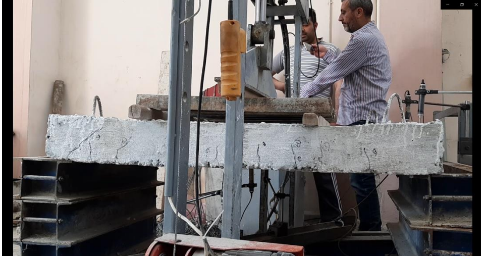
الشكل (8) شكل انهيار البلاطة (HS3-0%)
