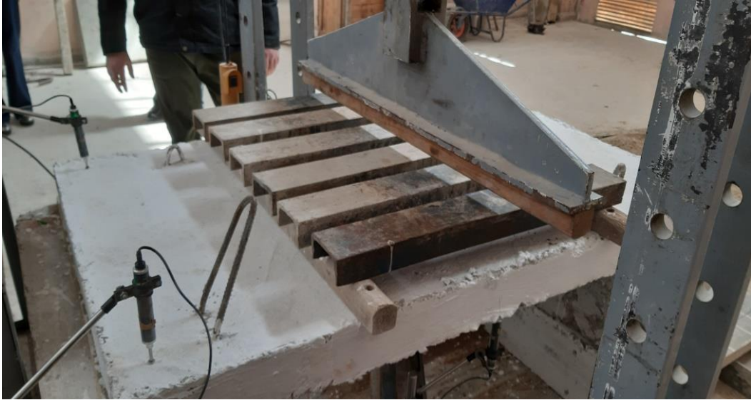
الشكل (4) منصة الاختبار وتوزيع الحمولات والحساسات
