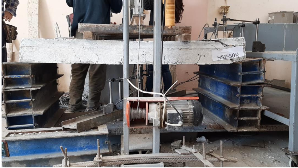
الشكل (13) شكل انهيار البلاطة (HS2-50%)
