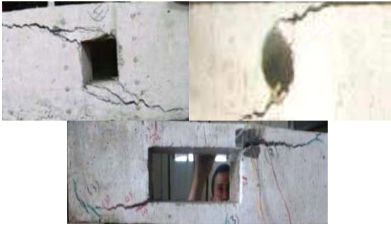
الشكل 5 : نمط انهيار الجوائز، من دراسة [AL-SHEIKH, 2014] [3]
