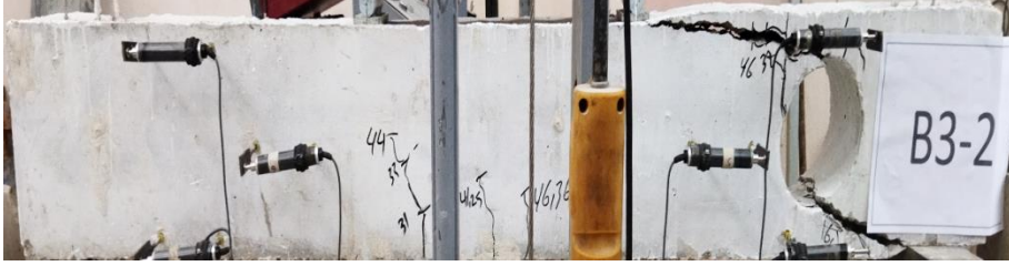
الشكل 23 : توضيح توزيع الشقوق و شكل الانهيار في الجائز B3-2
