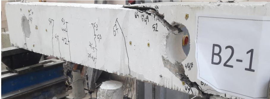
الشكل 17 : توضيح توزيع الشقوق و شكل الانهيار في الجائز B2-1
