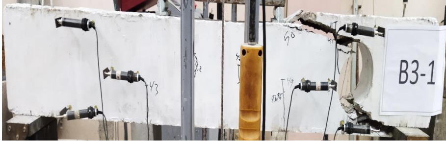
الشكل 21 : توضيح توزيع الشقوق و شكل الانهيار في الجائز B3-1
