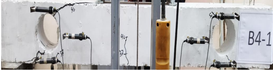
الشكل 25 : توضيح توزيع الشقوق و شكل الانهيار في الجائز B4-1
