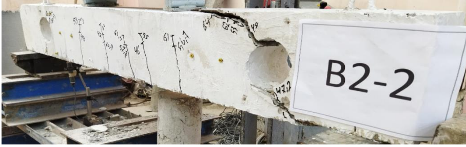
الشكل 19 : توضيح توزيع الشقوق و شكل الانهيار في الجائز B2-2
