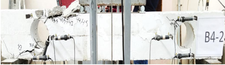
الشكل 27 : توضيح توزيع الشقوق و شكل الانهيار في الجائز B4-2
