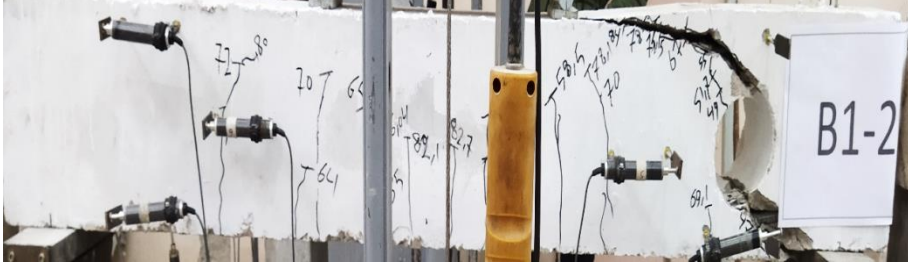
الشكل 15 : توضيح توزع الشقوق و شكل الانهيار في الجائز B1-2
