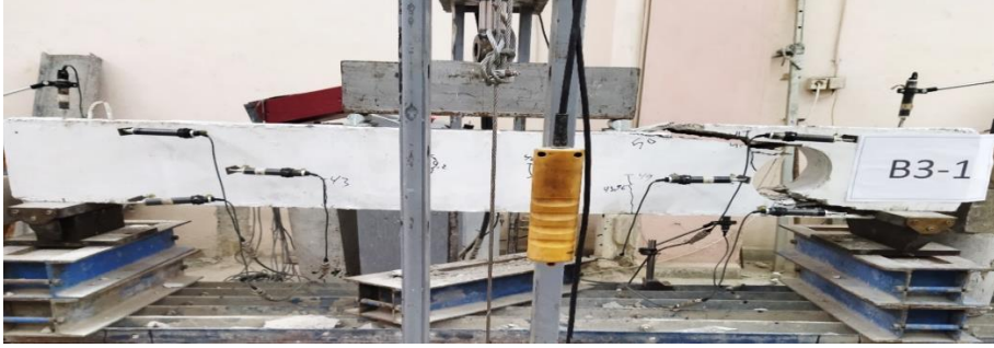
الشكل 32 : شكل الانهيار الإطاري بشقين متوازيين حول الفتحة و الذي يمكن تفسيره بعدم وجود تسليح إضافي خاص في منطقة الفتحة
