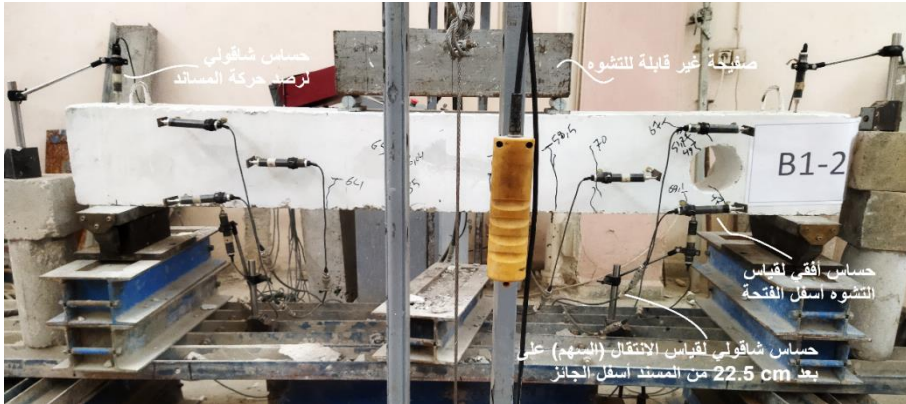
الشكل 8 : أماكن توضع الحساسات أثناء الاختبار
