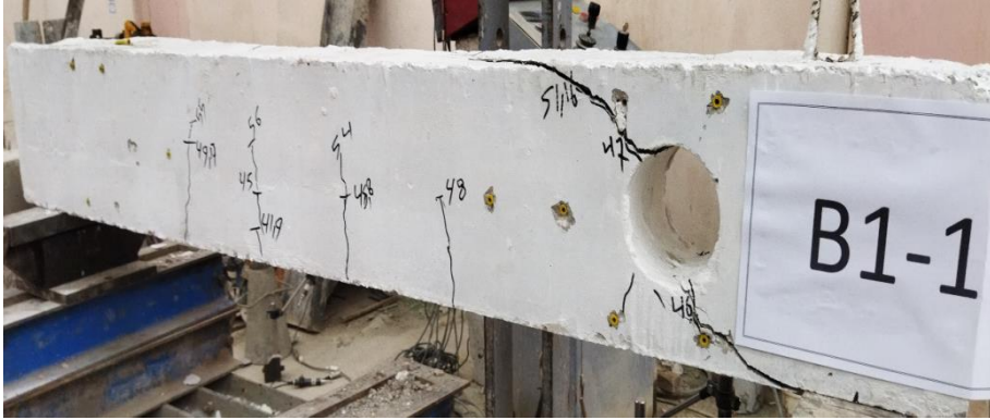
الشكل 13 : توضيح توزيع الشقوق و شكل الانهيار في الجائز B1-1
