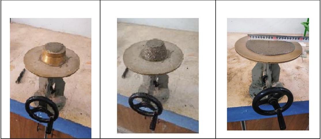
الشكل (4): صورة تظهر القرص الرجاج ( تجربة flow test )
