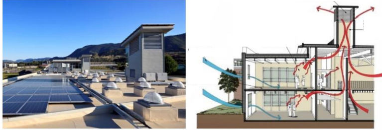
الشكل ( 24 ) يوضح فكرة عمل أبراج الرياح ، المصدر {36}
