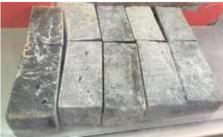
الشكل (7) شكل سطوح العينات بعد الكسر باستخدام جهاز الشد بالانعطاف.
