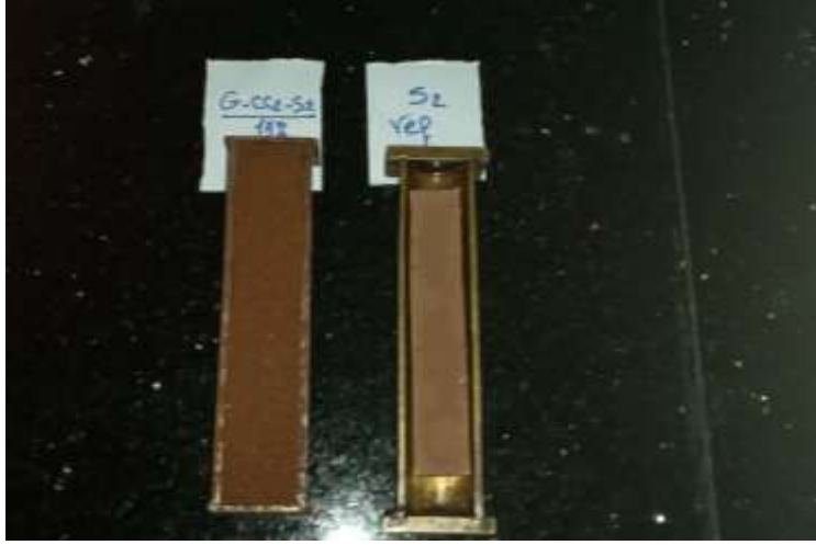
الشكل رقم (3) عينات التربة والتربة مع الجيوبولمر في قوالب الانكماش بعد التجفيف النهائي
