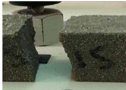
الشكل (7) شكل سطوح العينات بعد الكسر باستخدام جهاز الشد بالانعطاف.
