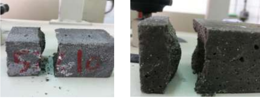
الشكل (9) شكل بعض سطوح العينات بعد الكسر باستخدام جهاز الكسر على الضغط.
