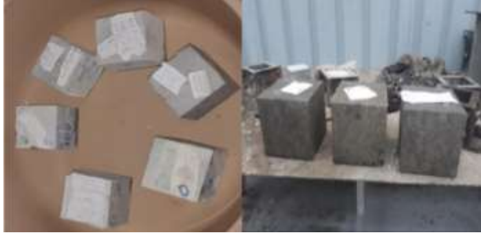
الشكل (4) نماذج من العينات المصبوبة من البيتون ذاتي التوضع
