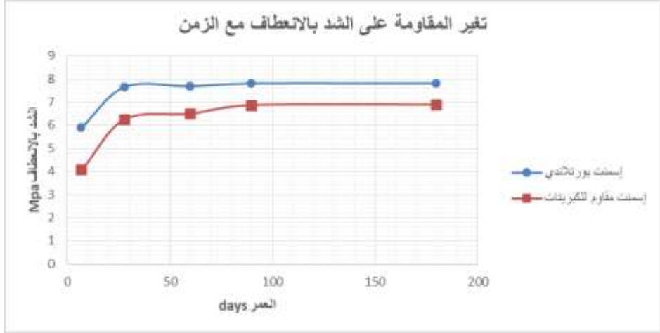
الشكل (6) تطور مقاومة عينات المونة الإسمنتية مع الزمن على الشد بالانعطاف.
