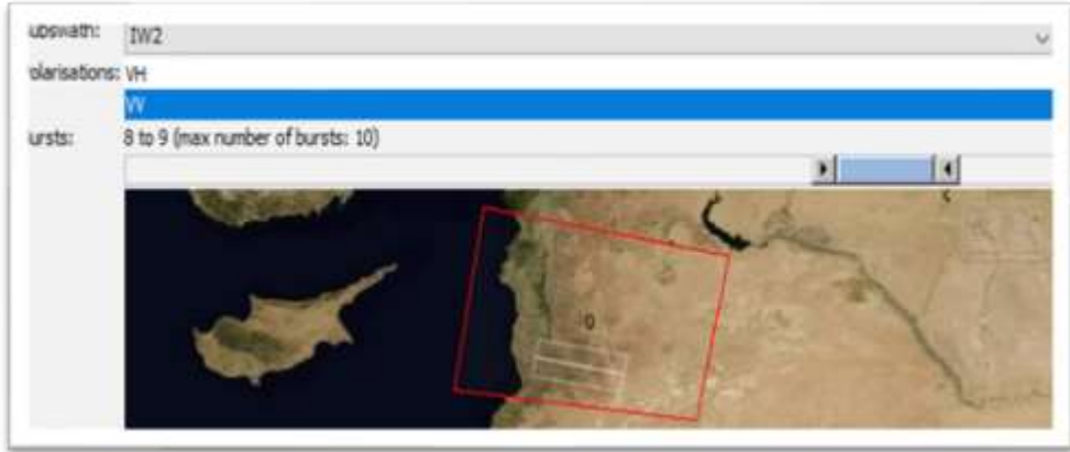
الشكل 6: الرقعة الفرعية IW2 والرشقات 8 و9 في منطقة تملكخ في حالة المدار الهابط
