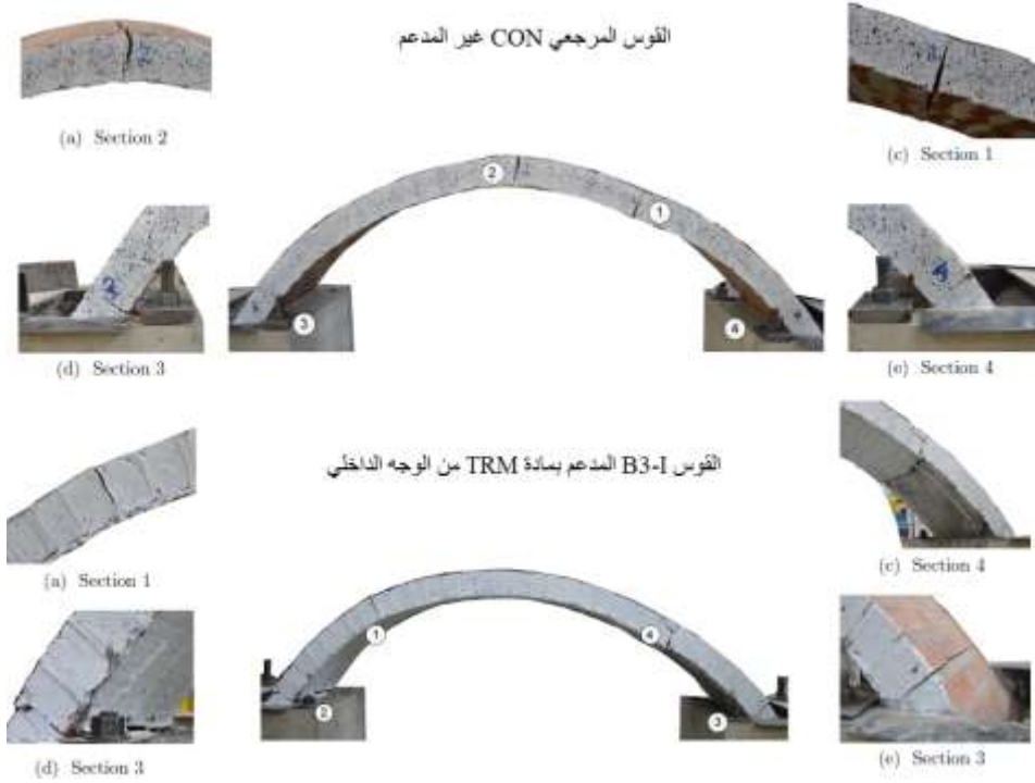
الشكل (10) نماذج الانهيار ومواضع المفاصل المتشكلة في القوسين المجريين
