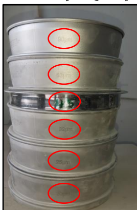
الشكل (2): المناخل المستخدمة للتحليل الحبي لغبار الإسمنت
