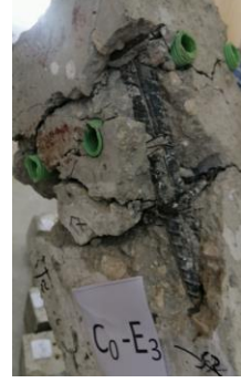
الشكل (7) مراحل انهيار العمود C0-E3
