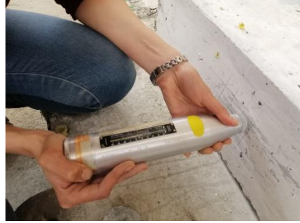
الشكل (10) اختبار مطرقة شميدت
