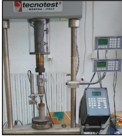
الشكل (7): الجهاز المستخدم لإجراء تجربة الضغط الحر
