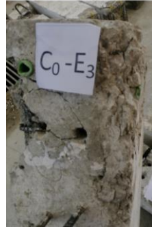
الشكل (7) مراحل انهيار العمود C0-E3
