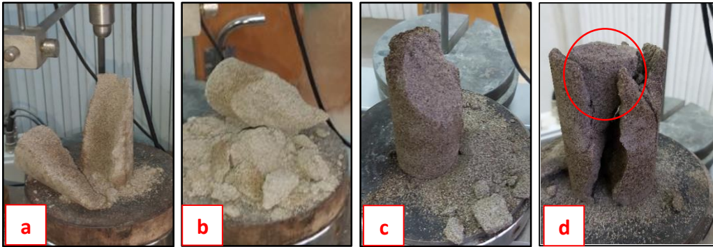
الشكل (22) الأنماط الرئيسية لشكل الكسر عند الانهيار
