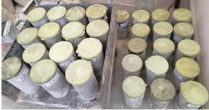
الشكل (11) مراحل تسوية سطح الأسطوانات بالكبريت
