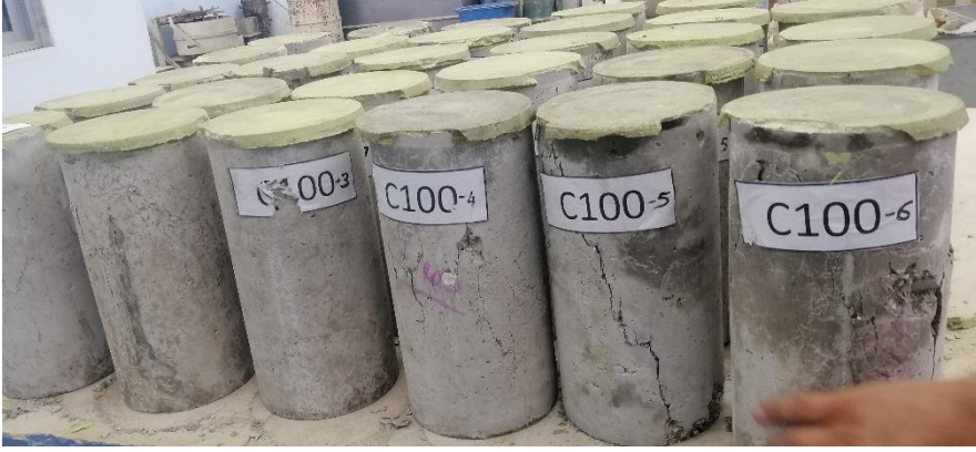
الشكل (13) شكل انهيار بعض العينات الأسطوانية
