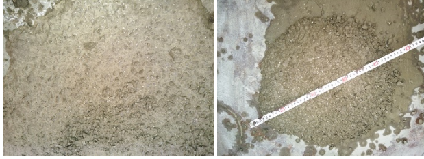
الشكل رقم (13) المزيج البيتوني التجريبي ذي المحتوى الاسمنتي 450 kg/m 3
