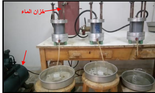
الشكل (12): تحضير عينة التربة الطبيعية لاختبار النفاذية الطبيعية
