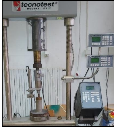
الشكل (7): الجهاز المستخدم لإجراء تجربة الضغط الحر
