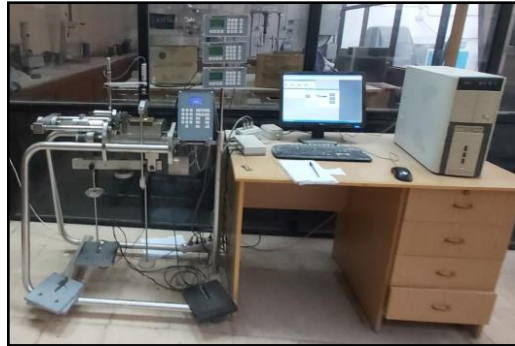
الشكل (10): تحضير عينة التربة المعالجة لتجربة القص المستخدم الشكل (11): جهاز القص المباشر
