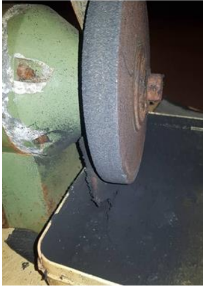
الشكل رقم (3) : طريقة طحن المطاط حتى الحصول على البودرة المطاطية
