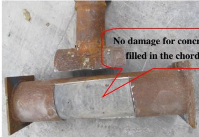
الشكل (6) : التقوية بالحشو الخرساني [8]
