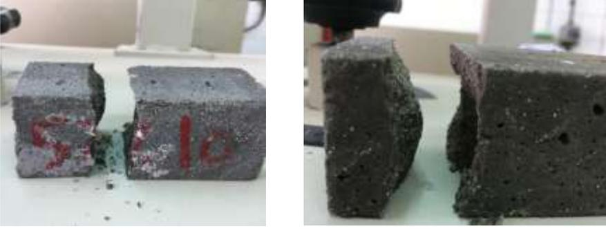
الشكل (9) شكل بعض سطوح العينات بعد الكسر باستخدام جهاز الكسر على الضغط.
