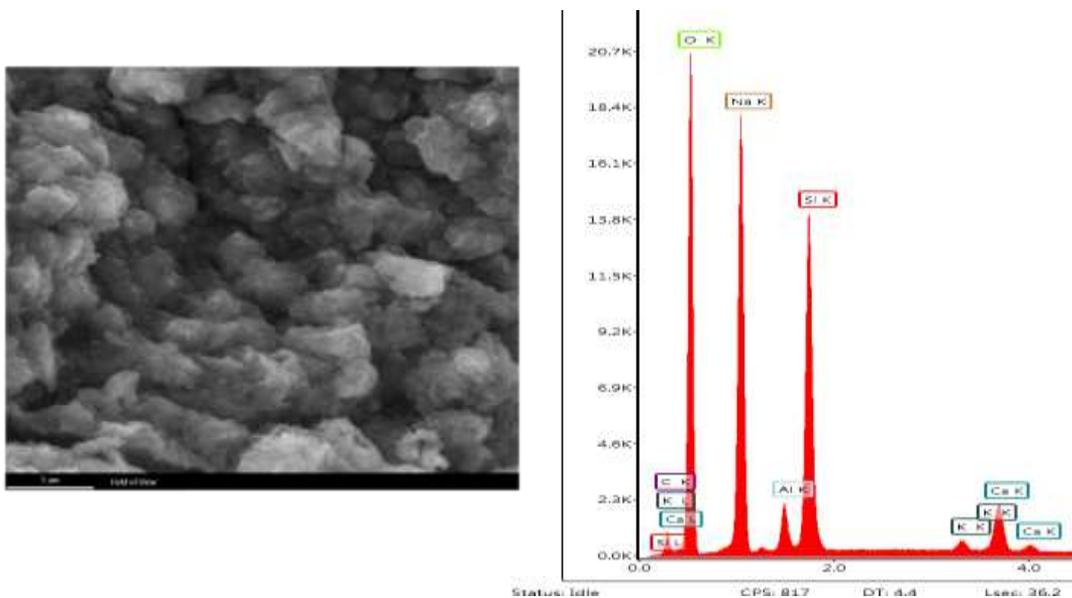
الشكل رقم (2) صورة المجهر الالكتروني الماسح (SEM) وتحليل الـ (EDX) لعينة الجيوبولمر
