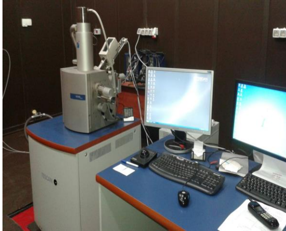
الشكل (7) المجهر الالكتروني الماسح في هيئة الطاقة الذرية بدمشق (VEGA II XMU)
