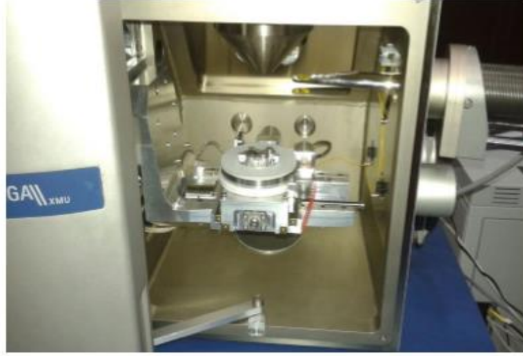
الشكل (8) حجرة المجهر مع حامل العينات والكواشف
