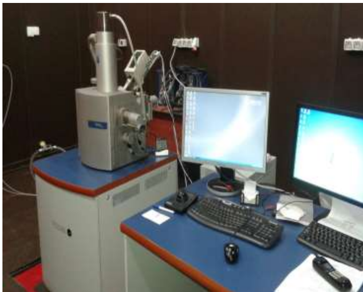
الشكل ( 5 ) المجهر الالكتروني الماسح في هيئة الطاقة الذرية بدمشق VEGA II XMU
