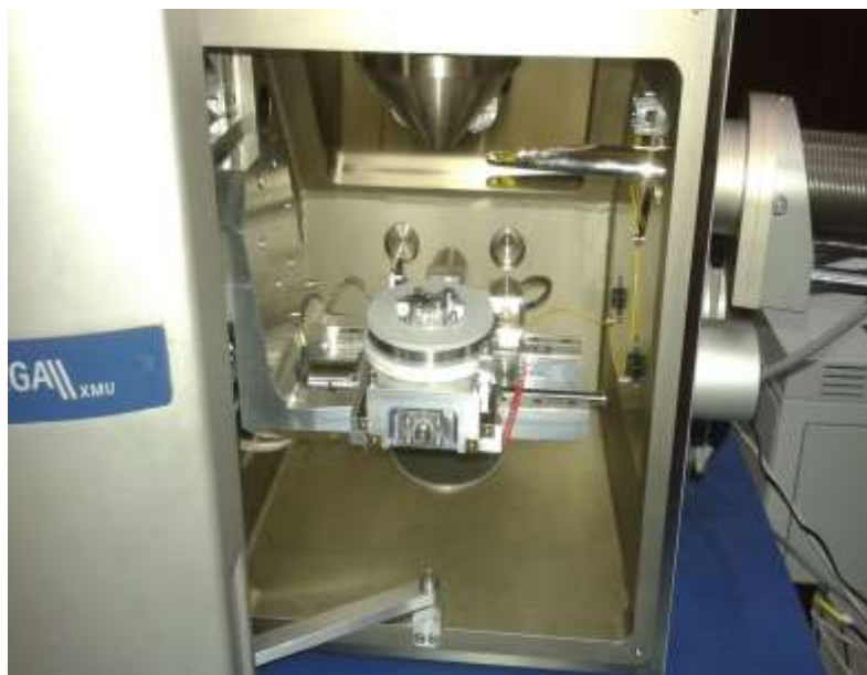
الشكل (6) حجرة المجهر مع حامل العينات والكواشف
