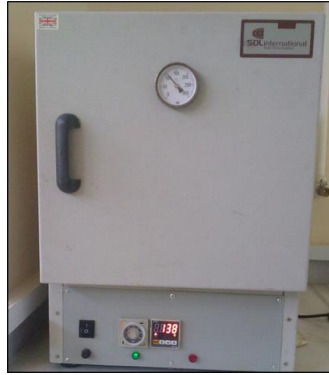
الشكل (7) توضيحي لحجرة التجفيف [1]
