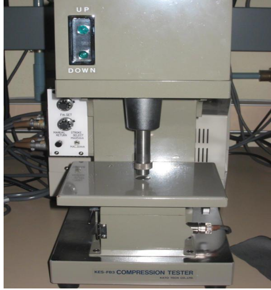
الشكل (5) جهاز قياس انضغاطية القماش
