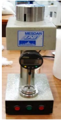
الشكل (12) جهاز قياس سماكة الأقمشة [2]
