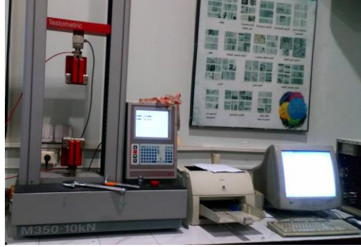
الشكل (11) جهاز اختبار قوة الشد
