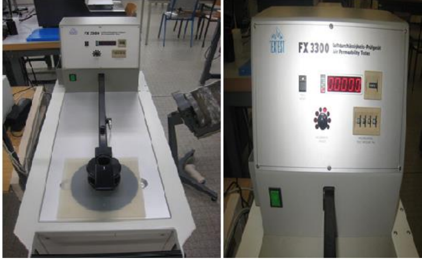
الشكل (2) جهاز اختبار نفوذية الهواء
