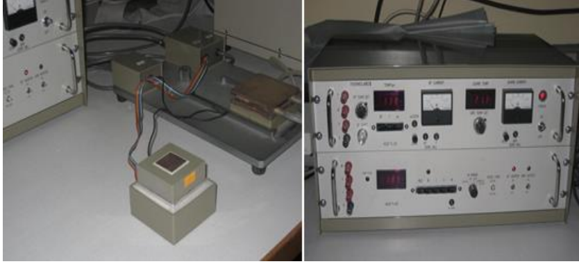
الشكل (4) جهاز قياس إحساس (الحرارة_ برودة)
